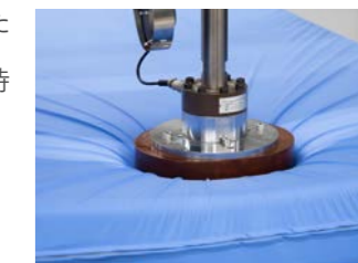
耐久試験機によるマットレスの加圧試験
